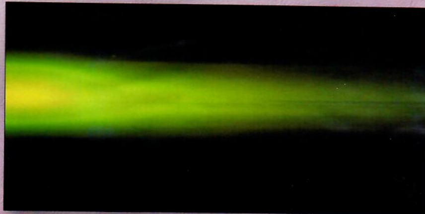
Рис. 16. Цифровая фотография флуоресценции опытного образца, полученная со стенда-макета камерой PixeLink PL-B778G (2592×1944 пикселя). Размер области изображения 3,6×2,7 мм. Использован фильтр ЖС-18
