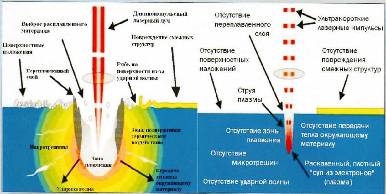
Рис. 3. Сравнительная схема воздействия сфокусированного пикосекундного излучения (справа) и излучения с более длительным импульсом (слева)
