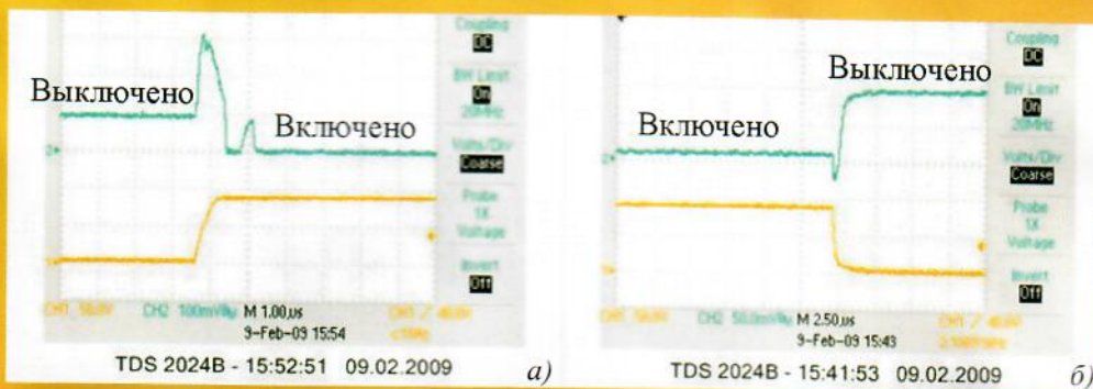
Рис. 13. Временные параметры переключения МЭМ элементов (синяя осциллограмма) под воздействием импульса управления с передним фронтом 0,5 мкс (желтая осциллограмма): a – передний фронт (включение, время «дребезга» контактов ~2 мкс); б – задний фронт (выключение)
