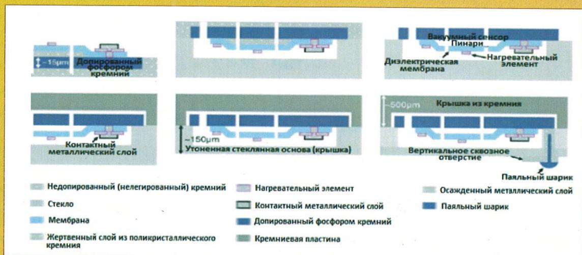
Рис. 7. Схема корпусирования С МЭМС с формированием вывода через утоненную стеклянную пластину и микрофотография С МЭМС со стороны стеклянной крышки со сквозными вертикальными отверстиями под контактные выводы [1]
