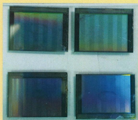
Рис. 7. Изображения кристаллов 3D package ИС после их разделения циклическим изменением температуры стековой сборки и последующей отмычки ацетоном в УЗ ванне
