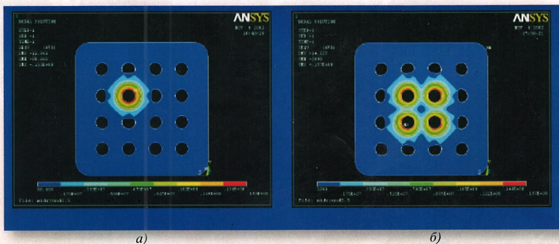
Рис. 21. Распределение напряжений сопла двигателей при воспламенении одного (а) и четырех (б) РМДТТ
