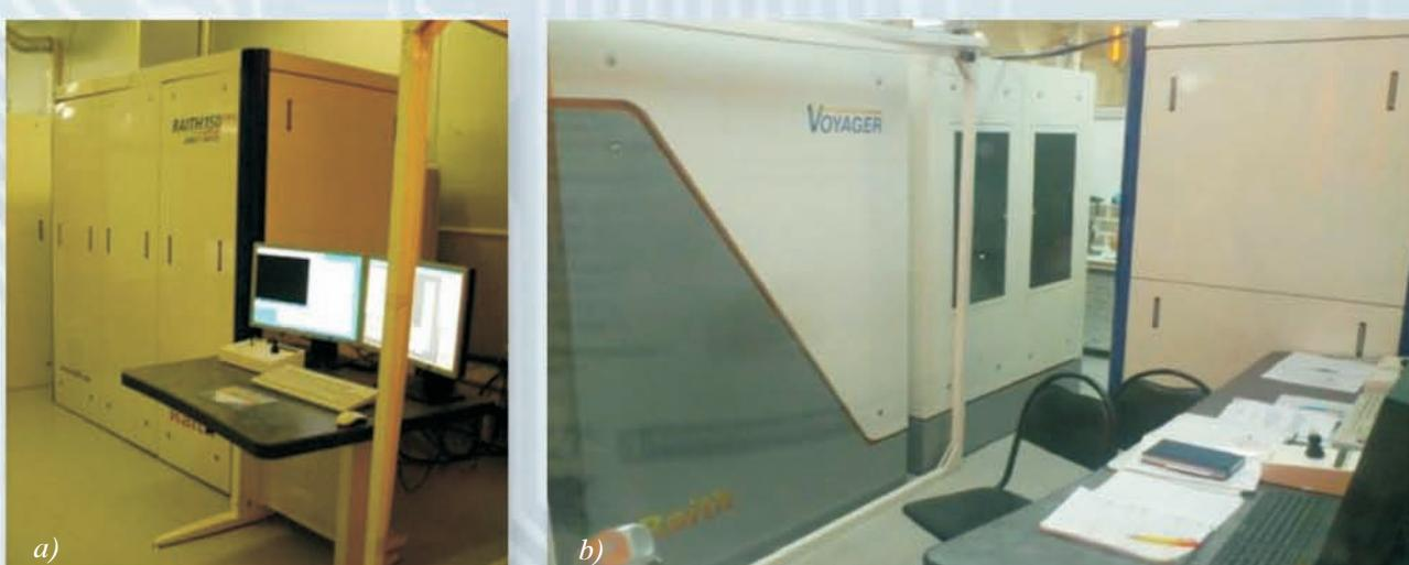
Рис. 10. Установки электронно-лучевой литографии для изготовления НЕМТ транзисторов
