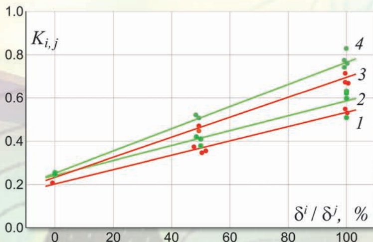
Рис. 4. Зависимость коэффициентов K_{1,2} и K_{1,3} от отношений \delta^1 / \delta^2 и \delta^1 / \delta^3 : 1 – K_{1,2} при \lambda_Q = 0,3 нм; 2 – K_{1,2} при \lambda_Q = 0,4 нм; 3 – K_{1,3} при \lambda_Q = 0,3 нм; 4 – K_{1,3} при \lambda_Q = 0,4 нм
