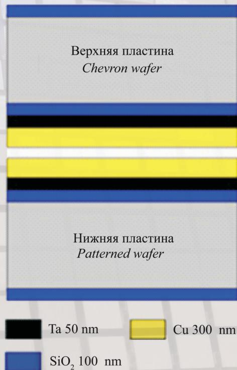
**Рис. 2. Схематическое изображение metallизации пластин при подготовке к сращиванию**
