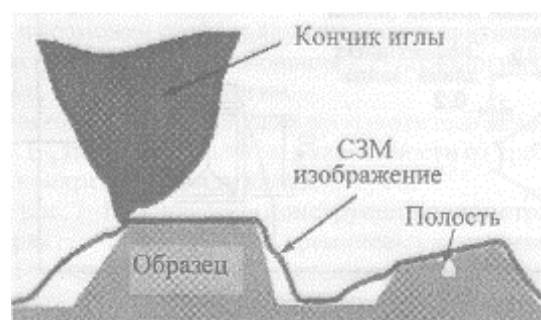
Рис. 4. Имитация процесса получения СЗМ изображения с помощью реального зонда
