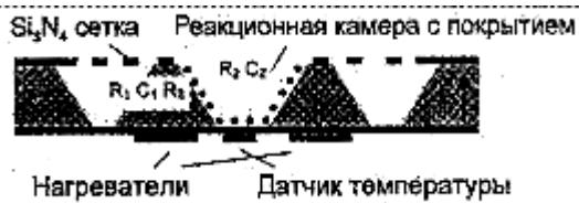
Рис. 10. Конструкция ПЦР микрореактора
