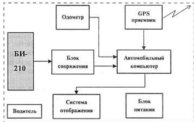
Рис. 1. Состав системы измерения и контроля геометрических параметров и качества дорожных покрытий
