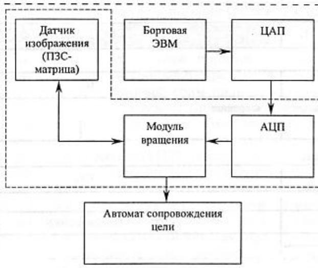
Рис. 1. Структурная схема системы компенсации вращения изображения
