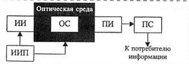
Рис. 1. Обобщенная структурная схема оптоэлектронного устройства:
