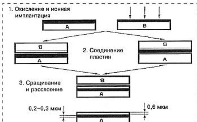
Рис. 1. Общая схема создания структур кремний-на-изоляторе: слева — методом DeleCut, справа — методом Smart-Cut®, отличающиеся операцией 2. Изолирующий оксид в схеме, использующей метод DeleCut, находится на опорной пластине A и не облучается
