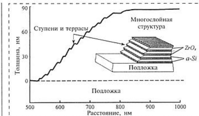
Рис. 1. ACM-профиль клина травления многослойной наноструктуры a-Si/ZrO $_x$  (TMX-2100 Accirex, Non-Contact). На вставке показано схематическое изображение клина травления
