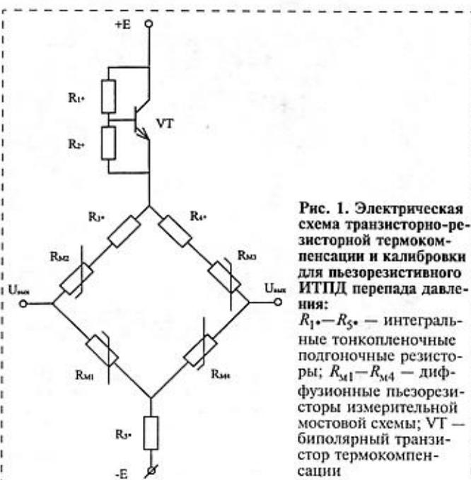
Рис. 1. Электрическая схема транзисторно-резисторной термокомпенсации и калибровки для пьезорезистивного ИТПД перепада давления:  $R_1$ — $R_5$  — интегральные тонкопленочные подгоночные резисторы;  $R_{м1}$ — $R_{м4}$  — диффузионные пьезорезисторы измерительной мостовой схемы; VT — биполярный транзистор термокомпенсации
