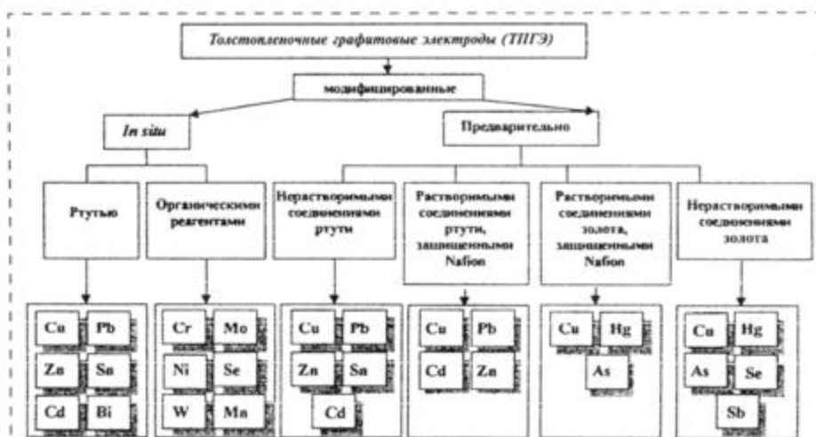
Рис. 2. Различные способы модифицирования толсто пленочных графитовых электродов
