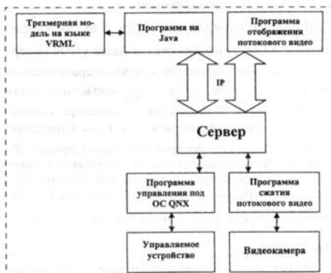
Рис. 1. Обобщенная структура комплекса программных средств для дистанционного управления учебной ГПС по каналам Internet
