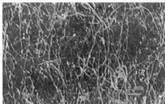
Рис. 1. РЭМ-изображение углеродных слоев с нанотрубками, изготовленных методом химического осаждения углерода на Ni фольге
