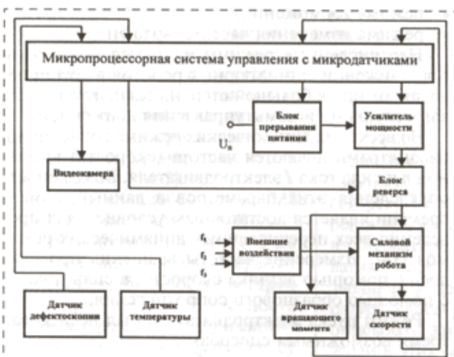
Рис. 8. Структурная схема управления миниатюрным роботом-трубоходом
