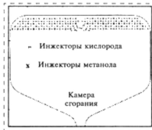
Рис. 7. Демонстрационный микроЖРД. Схема расположения инжекторов встречной подачи компонентов [13]
