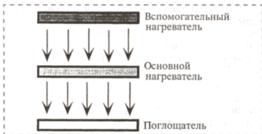
Рис. 4. Модель устройства для снятия характеристики q(T_a)
