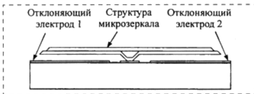
Рис. 1. Структура интегрального микрозеркала с электростатической активацией
