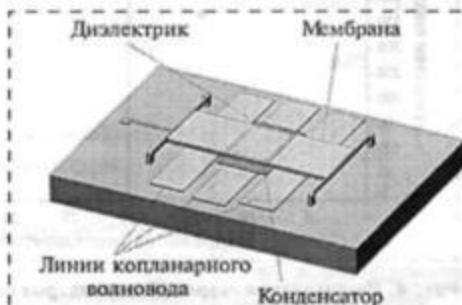
Рис. 1. Схематический вид переключателя (слева) и вид сверху мембраны и сигнальной линии (фотография справа)
