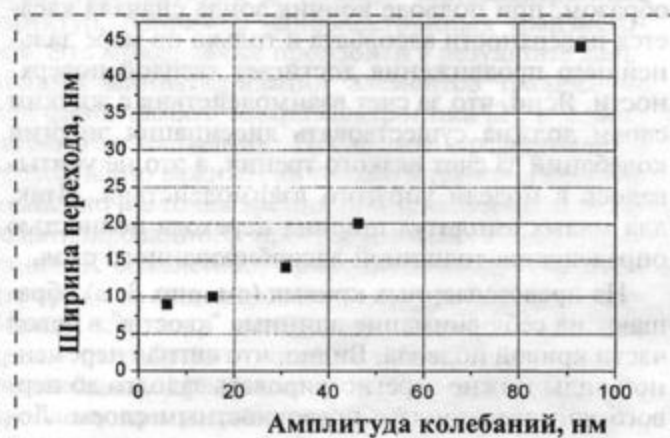
Рис. 4. Зависимость ширины перехода по сигналу "shear force" (амплитуда колебаний) от амплитуды свободных колебаний зонда
