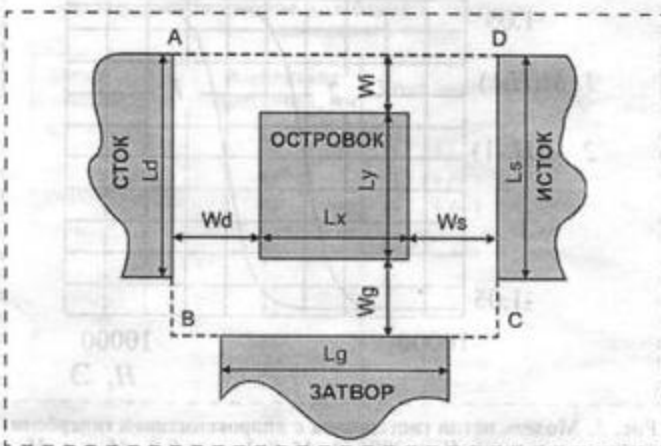
Рис. 1. Структура одноэлектронного транзистора
