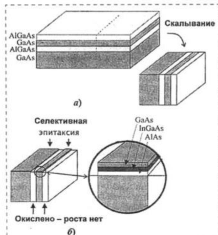
Рис. 4. Последовательность операций изготовления полосы InGaAs/GaAs заданной ширины:
