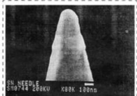
Рис. 1. Зонд для системы СБОМ
