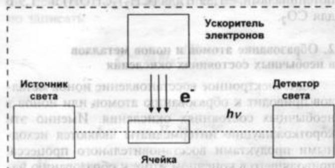
Рис. 1. Схема установки импульсного радиолиза
