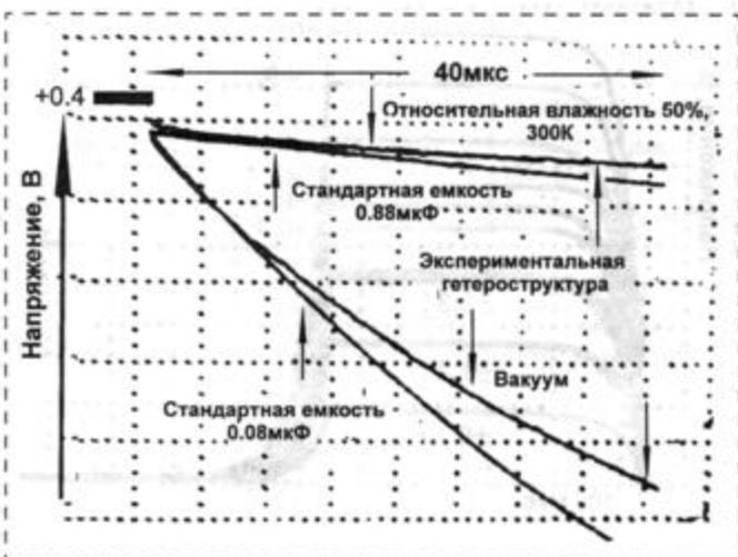
Рис. 8. Осциллограммы разряда гетероструктуры сплав/ $CsAg_4Br_{3-x}I_{2+x}/Ag$  прямоугольным импульсом напряжения в сухом воздухе и при относительной влажности 50 % (300 К)
