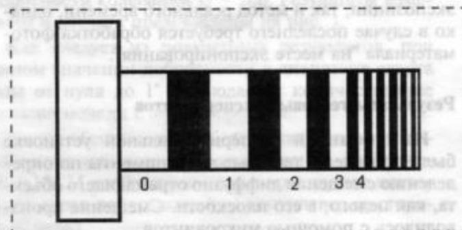
Рис. 2. Характерная интерференционная картина, возникающая при прогибе консольной балки
