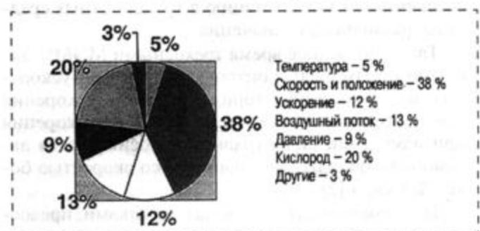
Рис. 1. Типовое распределение МЭМС-датчиков в составе автомобильной электроники по видам контролируемых физических величин
