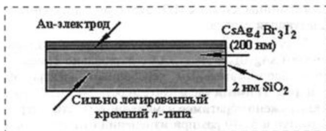
Рис. 3. Схема планарной сэндвичевой конденсаторной гетероструктуры  $n^+Si/CsAg_4Br_3-xI_2+x/Au$
