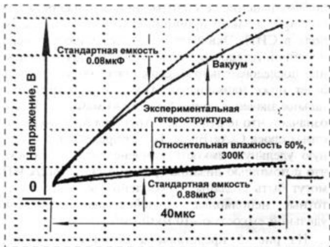
Рис. 7. Осциллограммы заряда гетероструктуры сплав/ $CsAg_4Br_{3-x}I_{2+x}/Ag$  прямоугольным импульсом напряжения в сухом воздухе и при относительной влажности 50 % (300 К)
