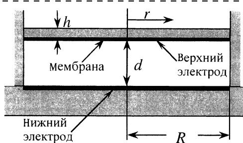
Рис. 4. Микромеханическая система с электростатическим управлением
