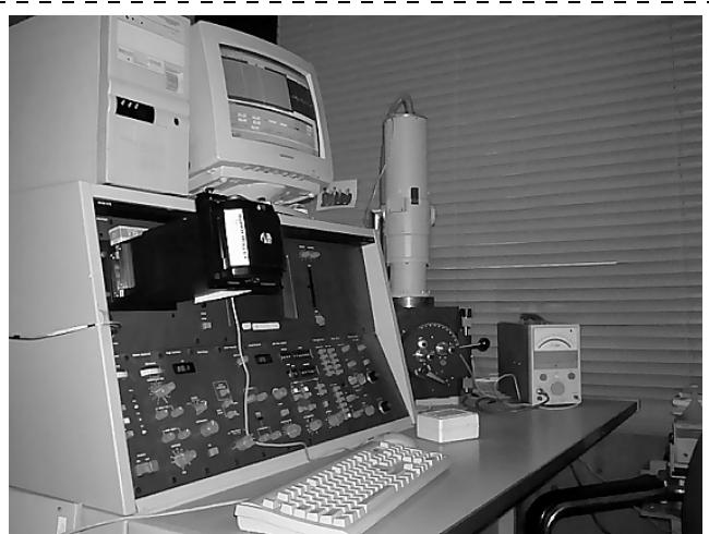
Рис. 6. Внешний вид установки высшей точности на основе растрового электронного микроскопа
