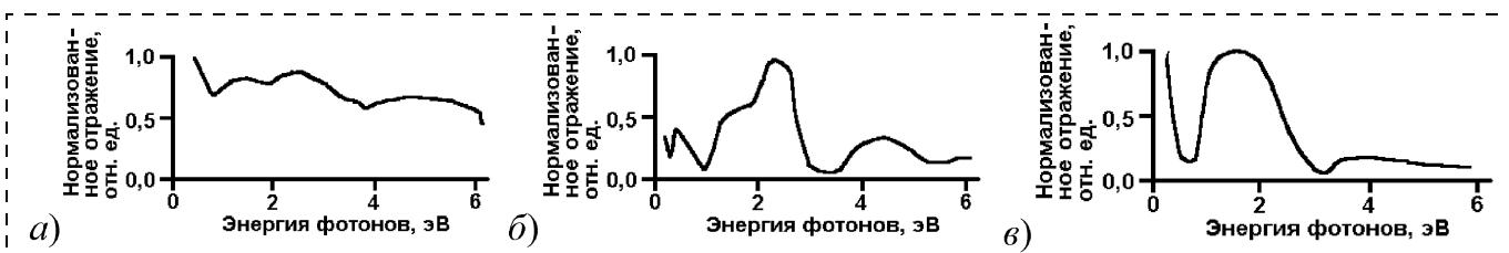
Рис. 1. Оптическое отражение для объемного образца галлия (а); опаловой матрицы (б) и опаловой матрицы, заполненной галлием (в)
