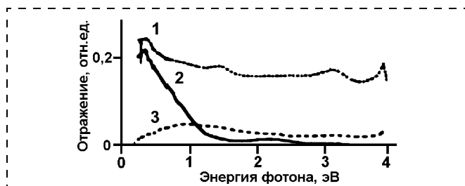
Рис. 9. Спектр отражения композита опаловая матрица — Sb (1 — размер наносфер 200 нм и 2 — размер наносфер 260 нм) и Sb (3) [13]
