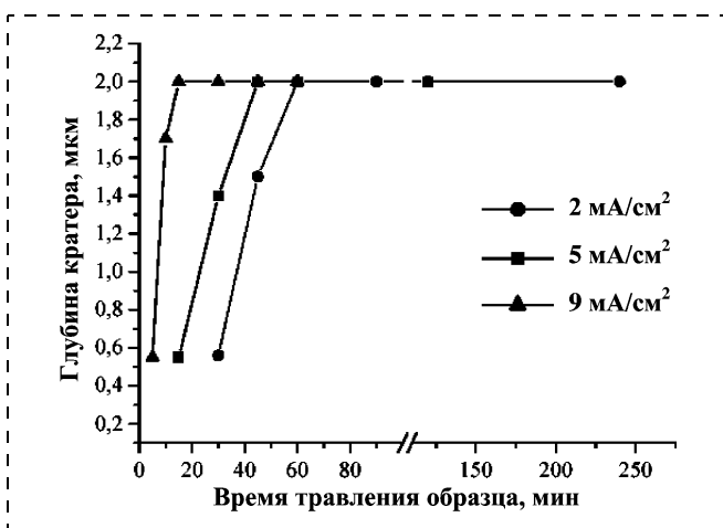
Рис. 2. Изменение глубины кратера от времени ГАТ кремния p -типа проводимости при различных значениях анодного тока травления
