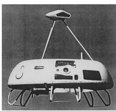
Рис. 5. Экспериментальный безэкипажный малоразмерный летательный аппарат *Gopher* (США) с нетрадиционной конструктивной схемой типа "летающая тарелка"
