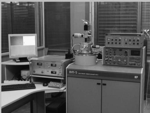
Аппаратура ионно-плазменного послойного препарирования. Разработка Центра микротехнологии и диагностики СПбГЭТУ
