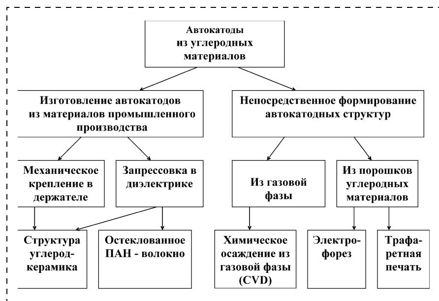
Рис. 1. Классификация основных направлений методов изготовления автокатодов из углеродных материалов
