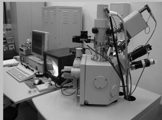
Аппаратура ионного-лучевого сверхлокального препарирования STRATA FIB 205 компании FEI
