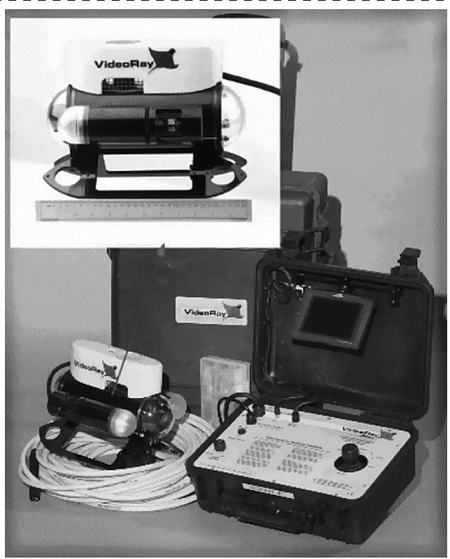
Рис. 4. Внешний вид ПМА VideoRay в комплектации Scout
