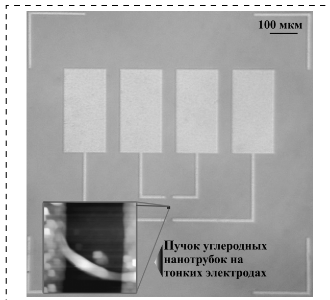
Рис. 1. Вид тестового кристалла с контактными площадками. На вставке: атомно-силовое изображение участка тонких электродов с лежащим на них пучком нанотрубок
