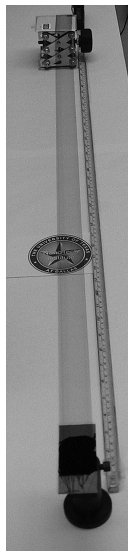
Рис. 5. Наноткань из нанотрубок. Эмблема снизу показывает прозрачность ткани
