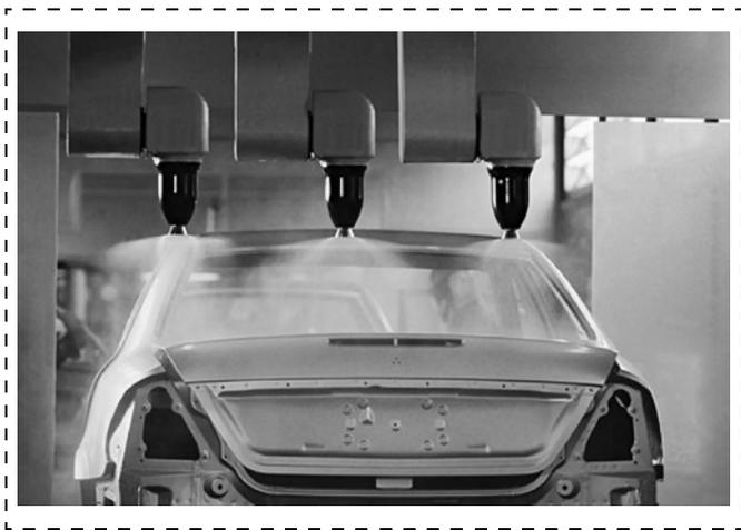
Рис. 1. Нанесение на автомобиль защитного слоя наночастиц
