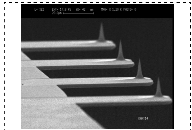
Рис. 3. РЭМ-изображение ("Stereoscan-360") четырехзондового кантилевера
