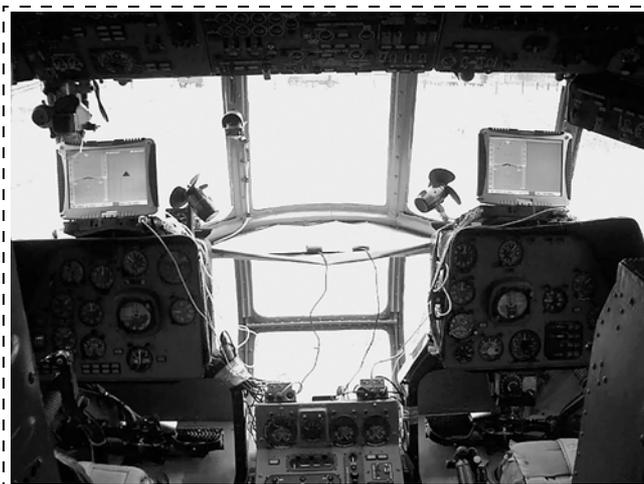
Рис. 4. Размещение ПНС на борту вертолета Ми-8
