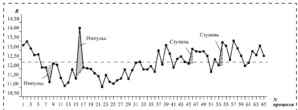
Рис. 5. Временной ряд показателя легирования B = R_s D для 65 процессов ионной имплантации фосфора при изготовлении кремниевых тензопреобразователей
