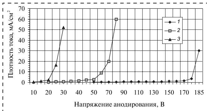
Рис. 3. Зависимость плотности тока от напряжения при анодировании Al фольги в фосфорнокислом (1), щавелевокислом (2) и сернокислом (3) электролитах (при прочих равных условиях и температуре электролита 6 °С)
