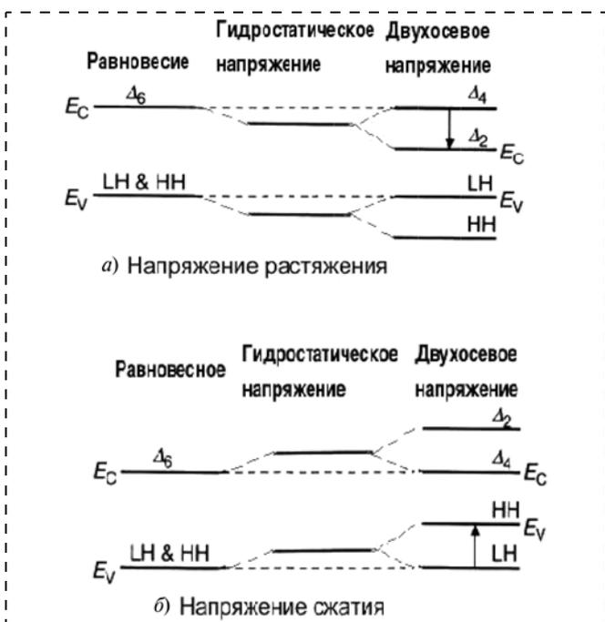
Рис. 7. Схематическое изображение эффектов двухосевого растяжения (а) и сжатия (б) в энергетической зоне кремния
