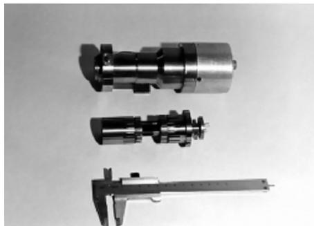
Рис. 5. Электромеханический привод (сверху) и передача РВПЗК 21,6×0,1
