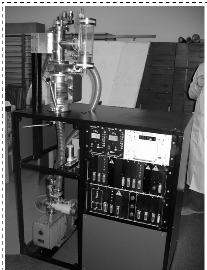
Рис. 12. Внешний вид лабораторной вакуумной установки модульного типа
