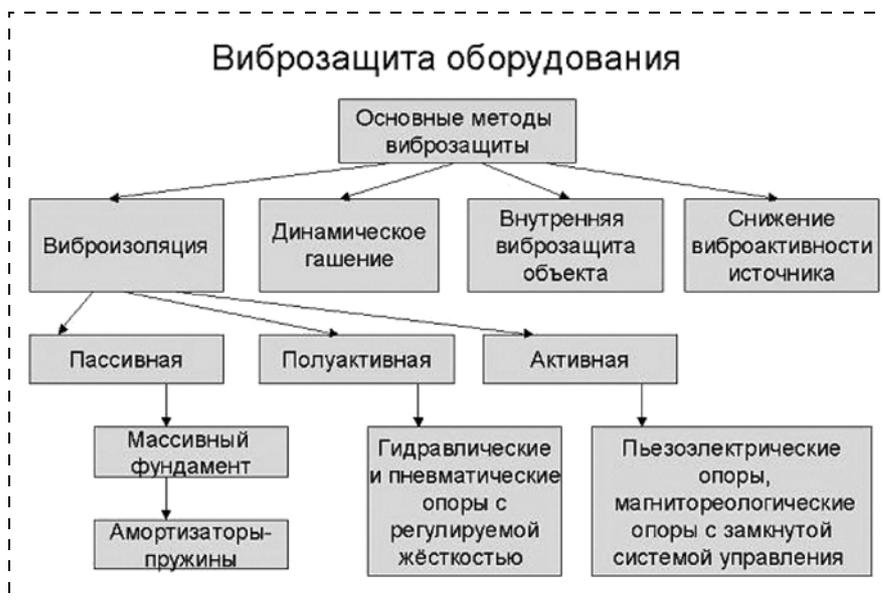
Рис. 2. Методы виброзащиты оборудования
