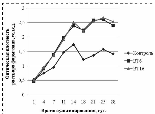
Рис. 6. Кривые изменения оптической плотности раствора формазана при культивировании фибробластов человека на полистерене (контроль) и образцах титановых сплавов с покрытием в динамике эксперимента (МТТ-тест)
