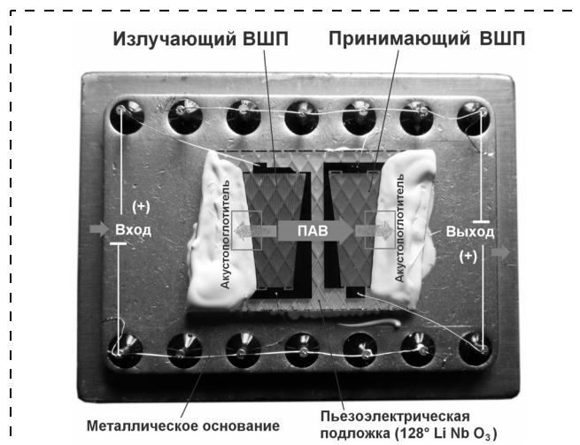
Рис. 3. Схема распространения основной и поглощения паразитных ПАВ (фото фильтра ФП-474 70B38vl D в корпусе DIP 151.15-8 19,5 × 14,5 мм с нанесенным акустопоглотителем)
