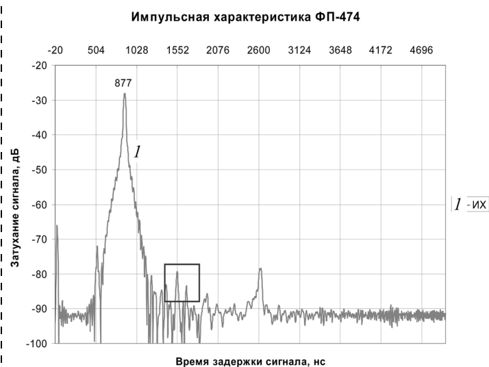
Рис. 4. Частотная (АЧХ и ГВЗ) (а) и импульсная (б) характеристики фильтра ФП-474 (70B38vl D) после устранения влияния паразитных отраженных волн
