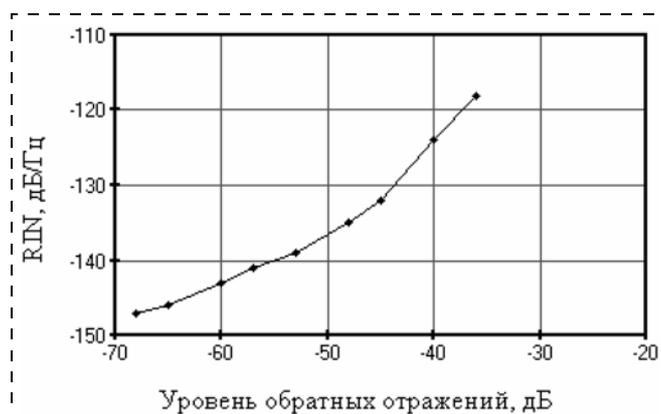
Рис. 3. Зависимость шумов лазерного излучателя от уровня оптических отражений
