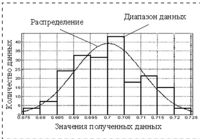
Рис. 5. Распределение амплитуд выходных треугольных импульсов
