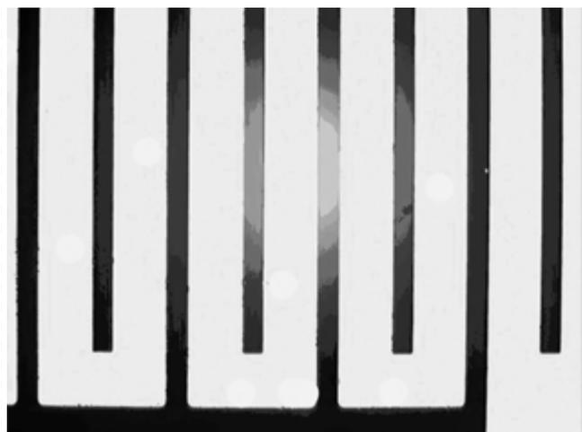
Рис. 2. Микрофотография фрагмента подложки для измерения электрофизических характеристик пленок
