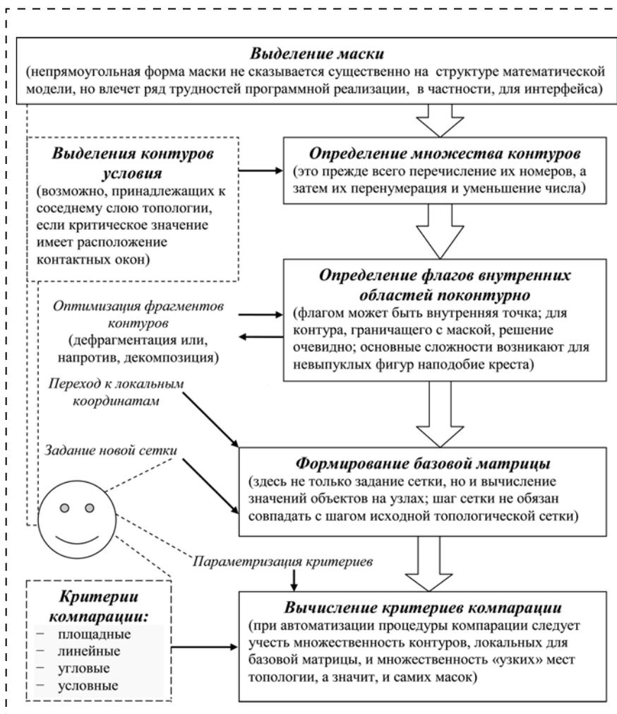
Рис. 6. Алгоритм применения метода базовой матрицы. Примечание: смайликом указан пользователь компаратора, штриховыми линиями — направления влияния, сплошными стрелками — потоки информации
