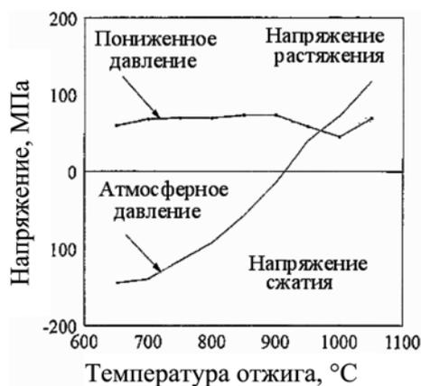
Рис. 2. Эффект влияния температуры отжига на релаксацию напряжений в поликристаллическом  $\text{Si}_{0,7}\text{Ge}_{0,3}$  [25]
