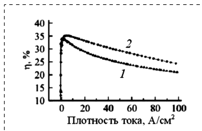
Рис. 6. Зависимости квантовой эффективности \eta от плотности тока для светодиодов ( \lambda = 450...460 нм) ЗАО "Светлана-Оптоэлектроника" (кривая 1) и коммерческих светодиодов фирмы Cree (кривая 2) при большой плотности тока [37]
