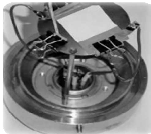
Рис. 3. Внутрикамерная оснастка, подложка с контактными площадками
